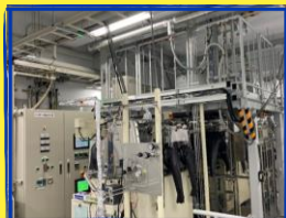
高温高圧Ga 2 N結晶成長装置
