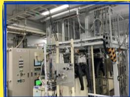
高温高圧Ga<sub>N</sub>結晶成長装置
