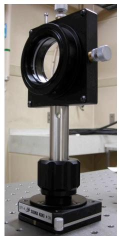
スを固定し、銀色のロッドをしっかりと持ち、ロッドが刺さっている黒いノブを時計回りに回すと固定が解放され、ロッドを上下に動かすことが出来るようになる。ロッド位置調整、逆方向にとまるまでしっかりと回せば固定される。
