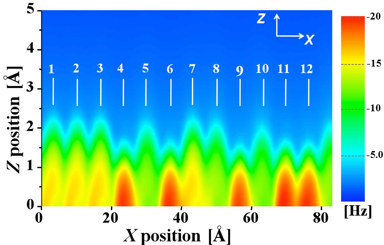
非接触原子間力顕微鏡を用いた室温環境下でのフォースマッピング。試料表面近傍において探針に働く力の空間分布をマッピングした。非接触原子間力顕微鏡を用いて測定した通常の凹凸画像では識別できない(つまり高さが同じ)原子が、フォースマッピングでは鮮明に識別できる(この図では、試料再表面における色が、黄色、赤、緑に対応)。
