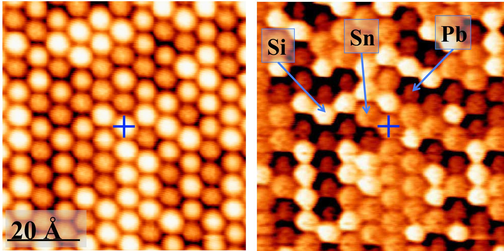
非接触原子間力顕微鏡を用いた室温環境下での凹凸像(左)と原子識別像(右)非接触原子間力顕微鏡を用いて測定した通常の凹凸画像では識別できない(つまり高さが同じ)原子が、原子識別像では鮮明に識別できる。同時測定するために、通常の凹凸像測定に距離変調を加え、その変調成分で測定した。
