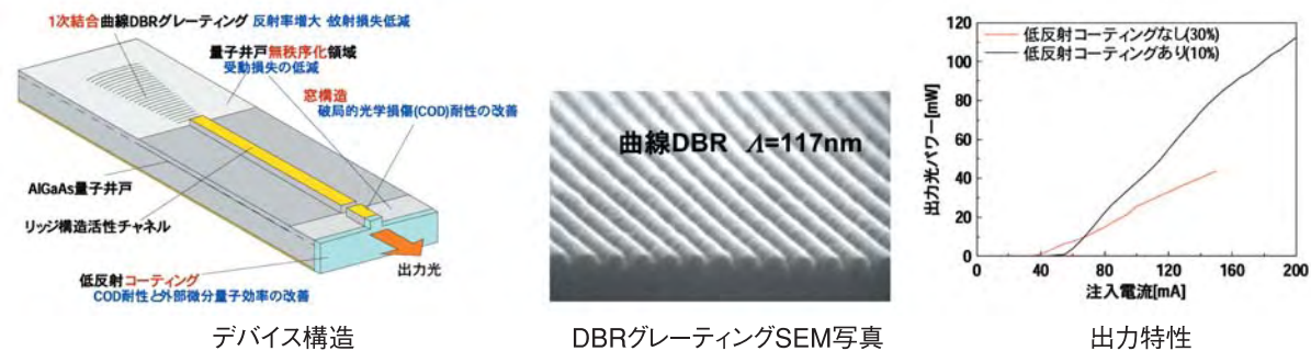
図1 曲線DBRグレーティングを用いた高出力DBRレーザ
