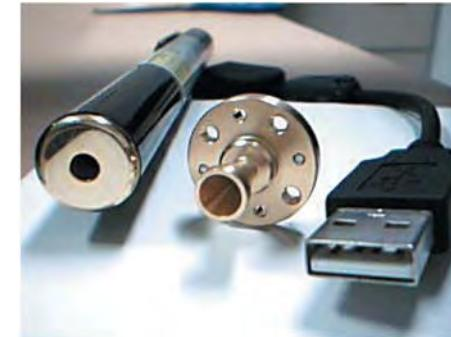
図4 300GHz帯ホーンアンテナ(中央)
