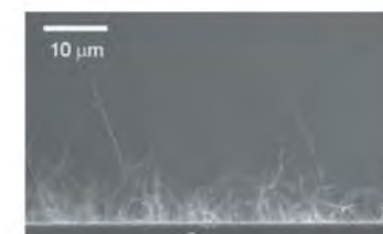
図8 印刷型CNT電子エミッター.
